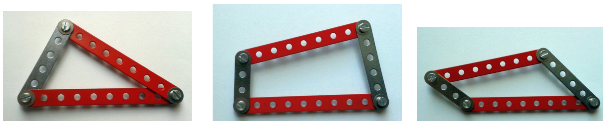
Obrázek 33: Na rozdíl např. od čtyřúhelníku je trojúhelník jednoznačně určen svými stranami
