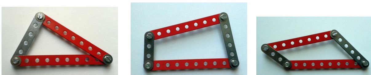
Obrázek 32: Na rozdíl např. od čtyřúhelníku je trojúhelník jednoznačně určen svými stranami
