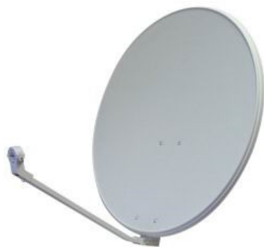
Obrázek 2.24: Nejrozšířenější satelitní anténa, tzv. „offsetová parabola“. Jedná se o výřez z plochy rotačního paraboloidu tak, aby přijímač v ohnisku (LNB konvertor) stál co nejméně v cestě dopadajícího signálu ( http://www.digizone.cz/ ).
