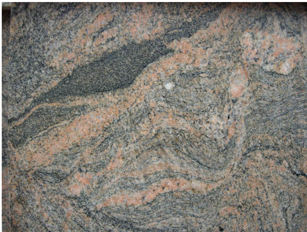
Obr. 9: Provrásněný migmatit. Tmavé polohy jsou bohaté na biotit, růžové na draselný živec a světlé na křemen. Fotografie migmatitu pochází z obkladu Poštovní spořitelny na Lannově třídě.
