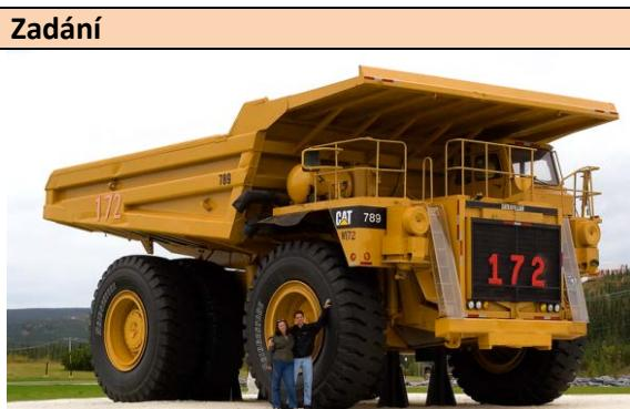
Nákladní auto Caterpillar má největší pneumatiky na světě. Jsou čtyři metry vysoké a váží pět tun, protože obsahují 890 kg oceli, aby vydržely při práci, kterou vykonávají. Používají se v uhelných, měděných, diamantových nebo zlatých dolech v Americe, Jižní Africe nebo v Austrálii.
