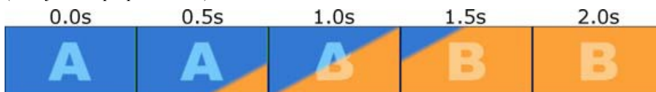
Obrázek 9: Pět snímků znázorňujících průběh dvousekundového přechodu úhlopříčného stírání.
