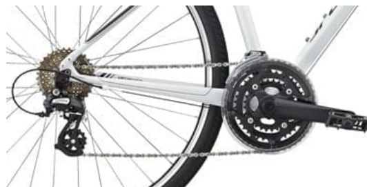
OBRÁZEK 3. Detail řetězového převodu cyklistického kola: hnané kolo s osou opatřenou pedály má 3 převodníky s různými průměry (vpravo), hnané kolo má 7 ozubených kol s různými poloměry (vlevo), obě kola jsou spojena článkovým řetězem. (Zdroj obrázku: [6])
