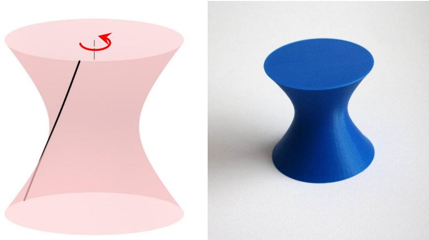
OBRÁZEK 7. Zadání a model plochy rotačního jednodílného hyperboloidu a vytištěný model na 3D tiskárně.
