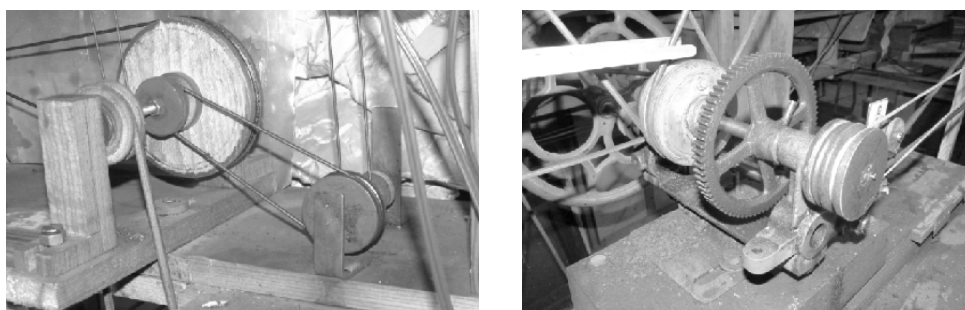
Obrázek 2: Příklad užití kombinace různých druhů převodů v technické části tzv. Krýzových jesliček, největšího pohyblivého mechanického betlému na světě v Muzeu Jindřichohradecka v Jindřichově Hradci. (Zdroj obrázku: autor příspěvku)
