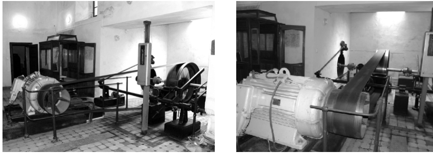
Obrázek 3: Příklad užití řemenového převodu ve strojově malé vodní elektrárně v mlýně na hradě a zámku v Jindřichově Hradci (vlevo), zbudované za pomoci Františka Křížíka (1847–1941), českého vynálezce, technika a průmyslníka, známého především vynálezem obloukové lampy, pomocí nichž v roce 1887 osvětlil ulice a náměstí v Jindřichově Hradci, detail užití řemenového převodu (vpravo). (Zdroj obrázku: autor příspěvku)
