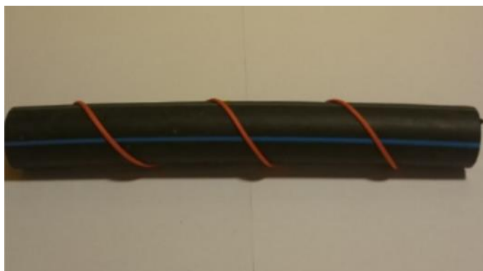
Přívodní hadice obmotaná provázkem místo odporového vodiče (model)
