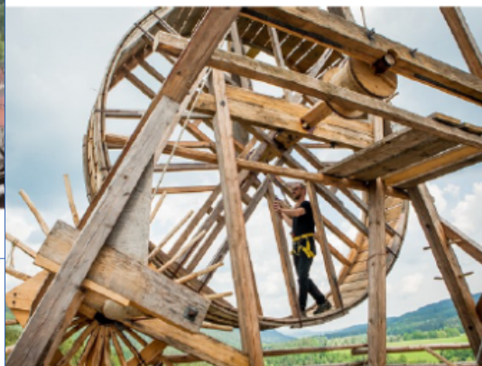
Kolo středověkého jeřábu na lidský pohon před jeho instalací na vrcholu věže Jakobínka
