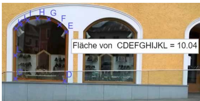
Abb. 27.3: Ergebnis der Flächenberechnung eines Schaufensters 1
