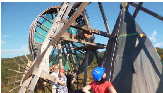
Obr. 13.1: Věž Jakobínka s rozestavěným středověkým lešením, převzato z [2] (vlevo); poháněcí šlapací kolo jeřábu před jeho instalací na věž, převzato z [3] (vpravo)
