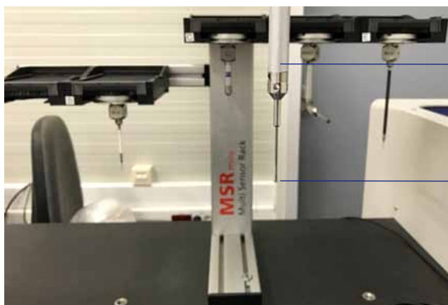
Obr. 6.2: Detail čidla na souřadnicovém zařízení
