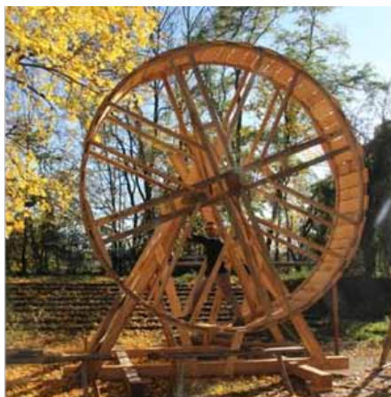
Obr. 13.1: Věž Jakobínka s rozestavěným středověkým lešením, převzato z [2] (vlevo); poháněcí šlapací kolo jeřábu před jeho instalací na věž, převzato z [3] (vpravo)
