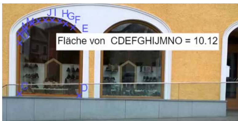
Abb. 27.4: Ergebnis der Flächenberechnung eines Schaufensters 2
