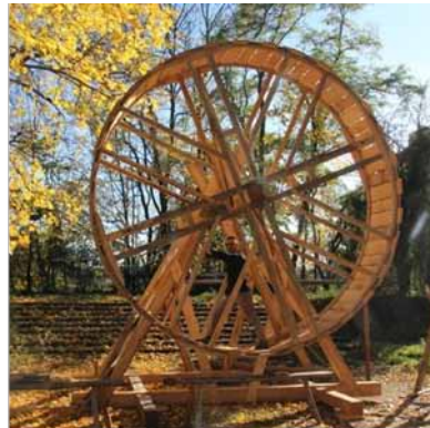
Abb. 13.1: Turm Jakobínka mit dem mittelalterlichen Baugerüst in Arbeit, übernommen von [2] (links); Tretrad als Antrieb des Kranes vor seinem Einbau zum Turm, übernommen von [3] (rechts)
