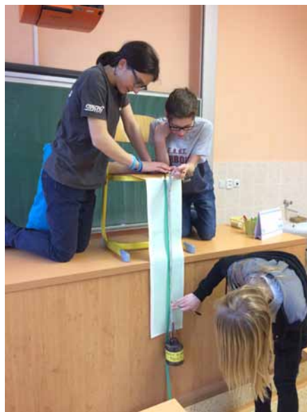
Obr. 2.2: Záběry z pokusu – statické prodloužení pramenu lana
