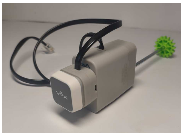
Obrázek 60: Sestavený mixér VEX GO s přidaným tlačítkem
