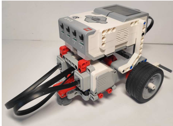
Obrázek 2: Sestavený robot LEGO Mindstorms (již s připojenými motory k řídicí jednotce)
