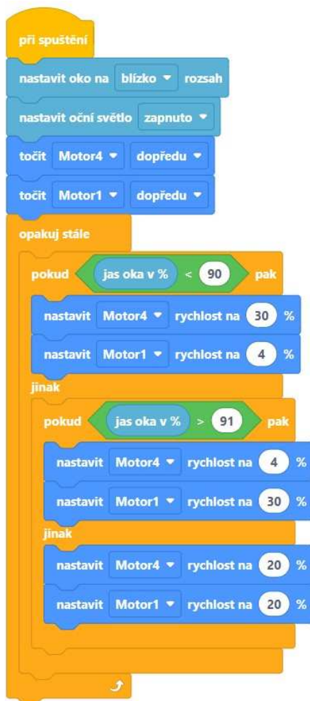
Obrázek 104: Nevhodné řešení úlohy 9.6 pomocí intenzity odraženého světla
