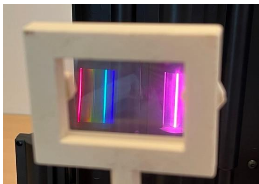
Obr. 1: Pohled na vodíkovou výbojku skrz difrakční brýle a difrakční mřížku.
