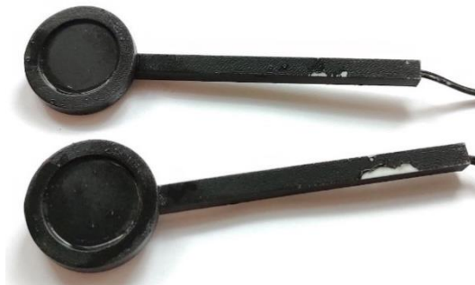
Obrázek 2: Detail na povrchovou úpravu, aplikovanou gumu.
