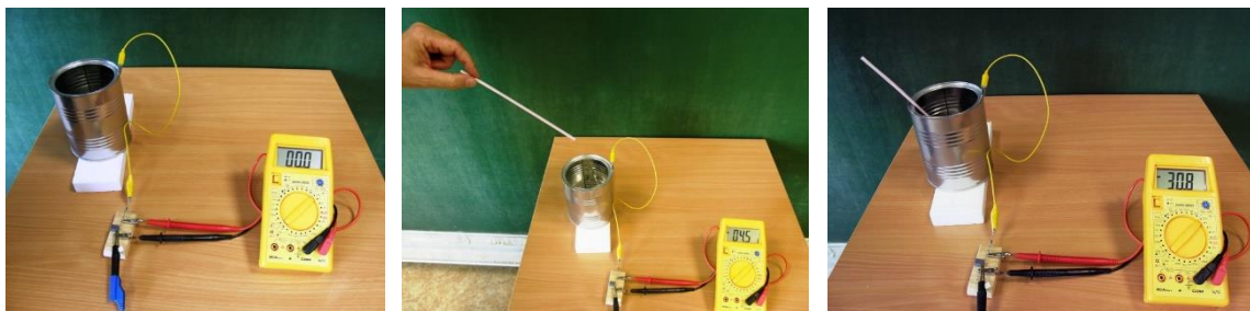
Obr. 5. Měření náboje kondenzátorem a multimetrem
