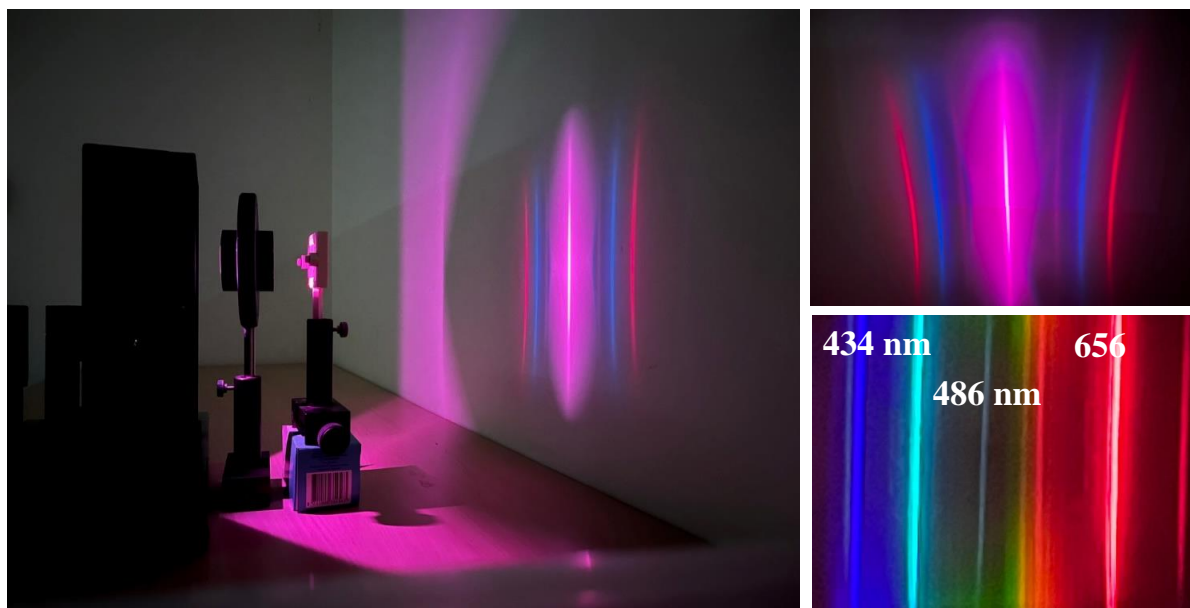
Obr. 2: Vlevo aparatura promítající na stěnu spektrum vodíkové výbojky, vpravo nahoře detail stínítka, vpravo dole fotografie spektra výbojky mobilním telefonem přímo skrz di-frakční mřížku, viditelné jsou tři výrazné čáry s vlnovou délkou uvedenou v nanometrech.
