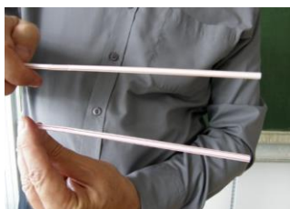
Obr. 2. Ze „vznášení“ jednoho brčka nad druhým díky odpuzování lze přibližně určit náboj brčka.
