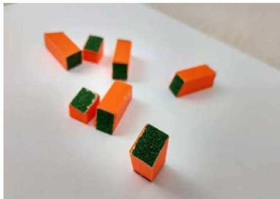
Obrázek 7: Úprava styčných ploch brusným papírem.
