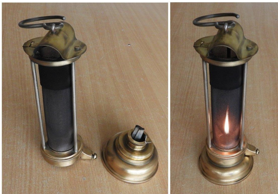
Obrázek 20. Vlevo je rozložená Davyho lampa - kahan a síťka, vpravo je zapálená Davyho lampa.
