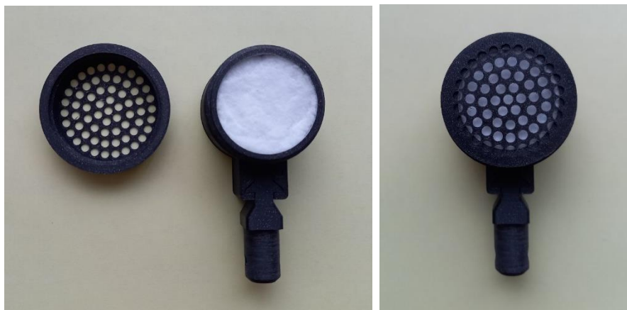
Obr. 11. Kontejner s chloridem draselným jako zářič beta.
