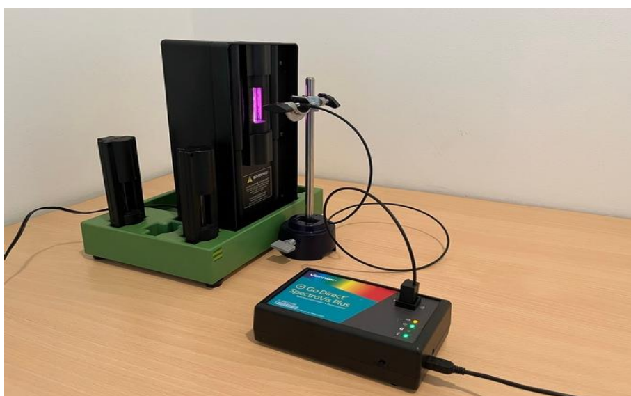
Obr. 3: Ukázka měření spektra výbojky pomocí čidla Vernier.
