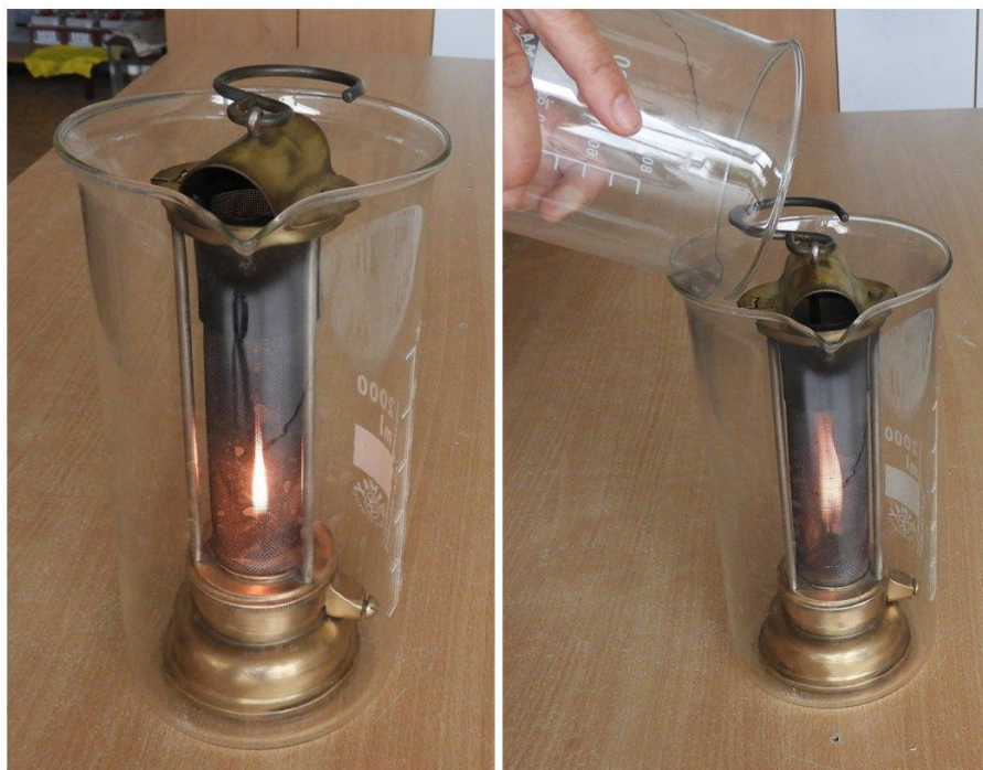
Obrázek 21. Simulace použití Davyho lampy v dole s bezpečnou atmosférou (vlevo) a po odkrytí ložiska hořlavého plynu (vpravo) - k lampě je přilévána směs propanu a butanu.
