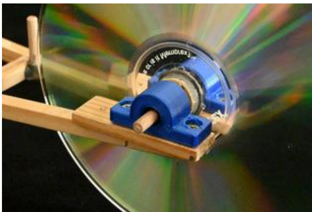
Obrázek 26 montáž přední nápravy s tištěným úchytem
