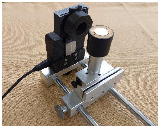
Obr. 3. Sestava pro fotonovou radiografii s detektorem MiniPIX EDU.
