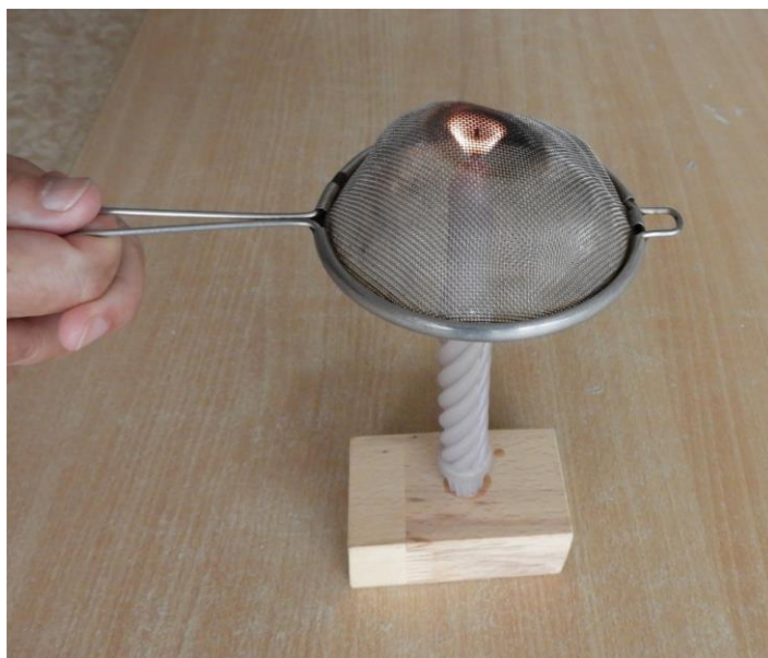
Obrázek 19. Princip Davyho lampy lze demonstrovat pokusem s cedníkem a svíčkou.
