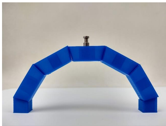
Obrázek 6: Samonosný oblouk s přidaným závažím.
