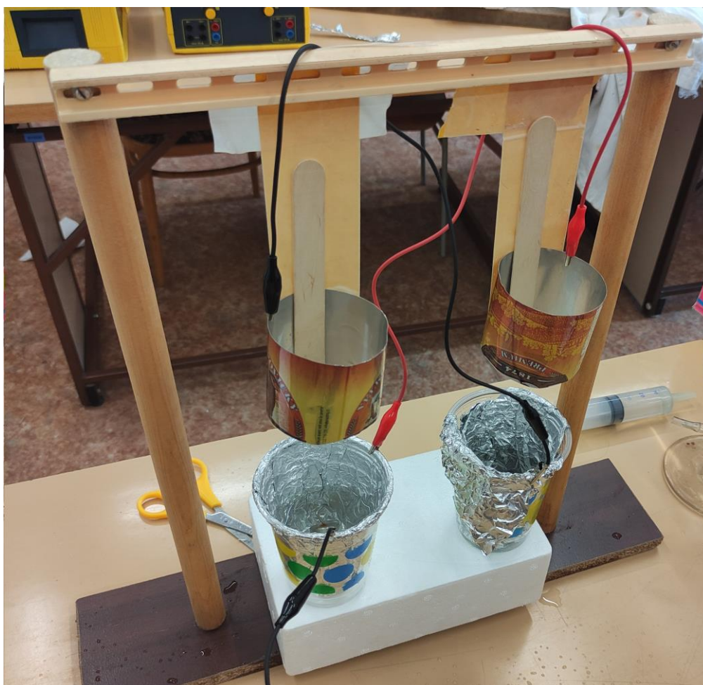
Obr. 2. Kelvinův kapkový generátor
