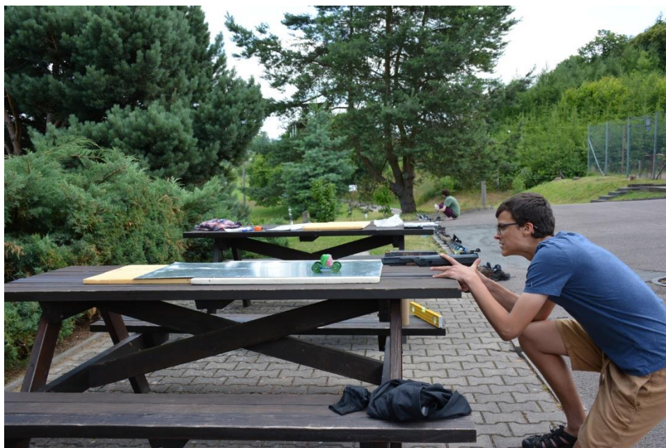
Obr. 1 Měření velikosti úst'ové rychlosti projektilu – střelba do vozíku
